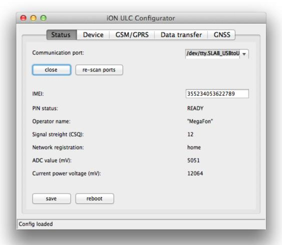
Для подключения выбирете последовательный порт к которому подключено устройтво из выпадающего списка «Comunication port» и нажмите кнопку «Connect».
